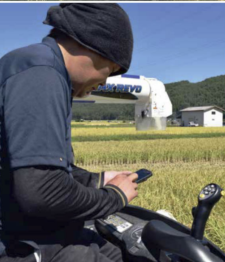
写真=1(中央)「コシヒカリ」の刈り取りを行う窪田さん。巧みに機械を操る。 写真=2(左下) 専用端末「KSASモバイル」を見ながら、連動したコンバインから送られてくるデータにて食味や水分量、収量を確認する。 写真=3(右下) 収穫されたもみを軽トラックに移す。
