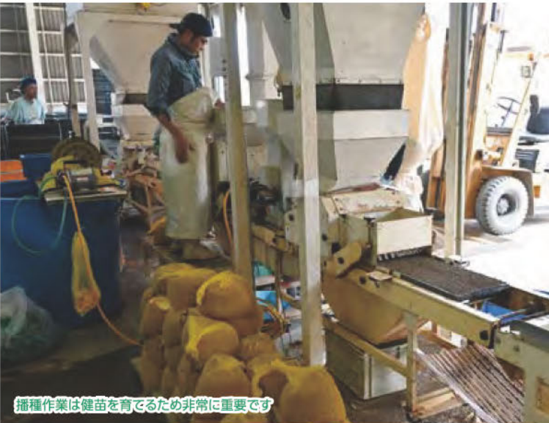
全自動播種設備は、箱供給装置、床土、覆土供給装置、播種プラントが連動して自動運転を行います。
